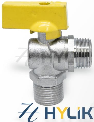
VÁLVULA DE ESFERA ANGULAR para gás combustível construída em latão com extremidades rosqueadas. São desenvolvidas para uso em gás combustível temperatura mínima de -40°C e máxima de 50°C. Possui acionamento com trava de segurança, haste com duplo anel.
